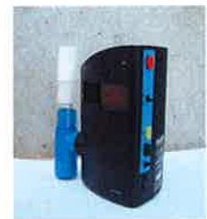
<スモーカーライザー> 呼気中の一酸化炭素(CO)濃度を測定する器械です。
