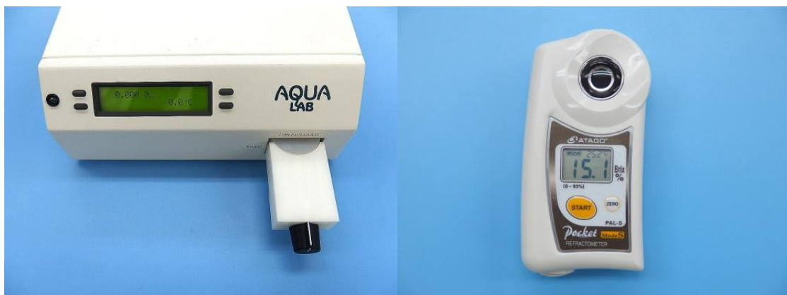
写真 3 水分活性測定装置 (左) と糖度計 (右)
