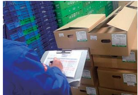
入荷した原料肉の表示内容(畜種、部位、原産地など)や期限表示が、入荷情報と整合していることを確認・記録します。
