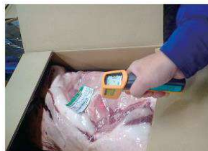
入荷した原料の表面温度を測定し、決められた温度が守られていることを確認します。
